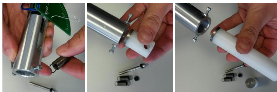
Sortir l'accessoire propulsion d'une bille puis placer l'accessoire propulsion d'un chariot en insérant d'abord la partie métallique
