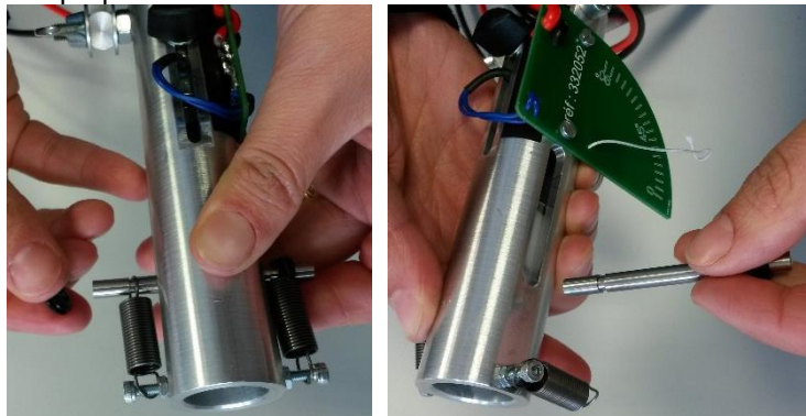
Enlever, sur l'axe reliant les deux ressorts, les deux embouts caoutchoucs. Faire glisser l'axe hors du lanceur
