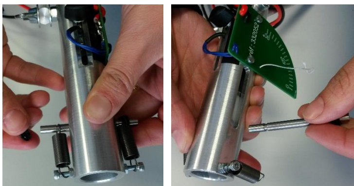
Fig. 4 Enlever, sur l'axe reliant les deux ressorts, les deux embouts caoutchoucs. Faire glisser l'axe hors du lanceur.
