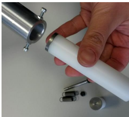
Fig. 5 Sortir l'accessoire propulsion d'une bille. Placer l'accessoire propulsion d'un chariot en insérant d'abord la partie métallique.
