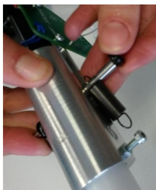
Fig. 6 A travers les ouvertures latérales du lanceur, insérer l'axe de maintien des ressorts en passant par l'orifice de l'accessoire. Remettre les embouts caoutchoucs.
