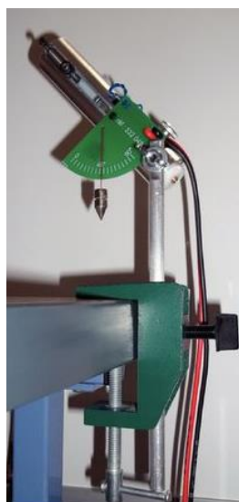
Fig. 2- Lanceur balistique monté sur paillasse avec sa fixation pour paillasse
