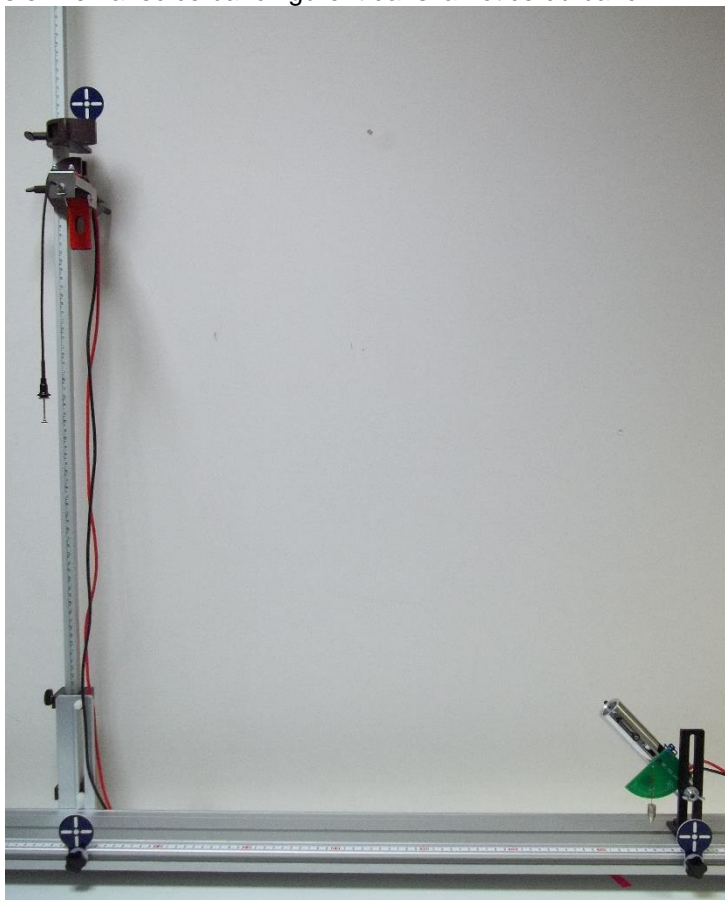
Fig. 8- Lanceur balistique et chute libre montés sur banc de mécanique Expérience du singe et du chasseur
