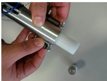
Fig. 7 Placer les ressorts de façon à maintenir cette tige.
