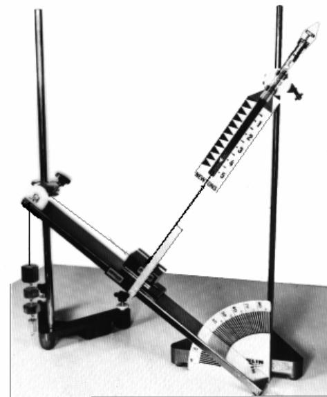
Montage simple réalisé avec 1 plan incliné, 1 dynamomètre de cours, 2 supports avec tiges, 2 noix de serrage, 1 boîte de masses à crochet. Cet appareil permet de mesurer les forces appliquées à un mobile en équilibre sur un plan incliné : composante utile (parallèle au plan) et réaction normale du plan.
