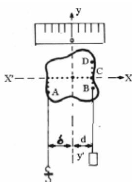
Montrer que si la force  $\vec{F}_B$  garde la même intensité et la même direction alors le déplacement du goujon sur l'axe de cette force (en C ou D sur le schéma ci-dessus) ne modifie pas l'équilibre du corps.
