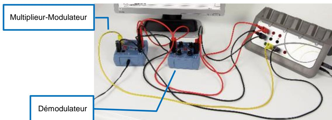
Brancher la sortie du Multiplieur-Modulateur sur l'entrée directe 1.
