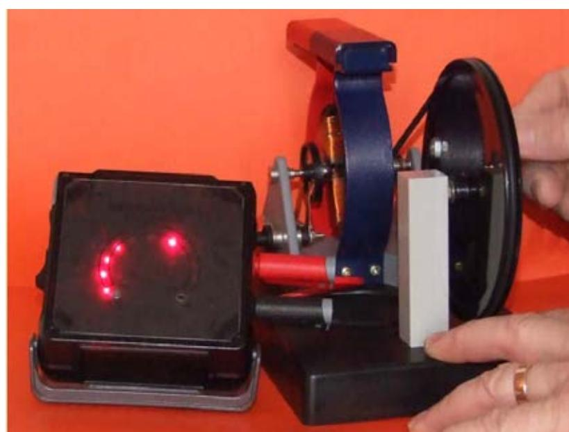
La puissance électrique disponible est fonction croissante de la tension générée aux bornes de l'alternateur. En augmentant la vitesse de rotation on
