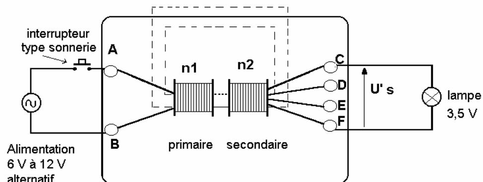
Sans noyau, la bobine est peu résistante, et le courant est alors important : la bobine chauffe et le vernis protecteur pourrait être détruit si on maintenait le courant (notamment en 12 V). Afin d'éviter cet inconvénient, il est conseillé de placer un interrupteur poussoir dans le circuit primaire.
