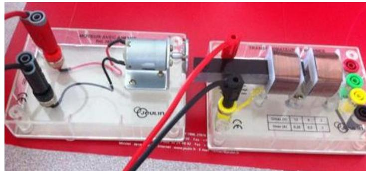
Le moteur étant alimenté entre 3 V et 3,9 V, recherchez par tâtonnement la meilleure position de la bobine et du noyau, face au disque en rotation supportant les aimants.
