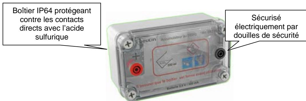
L'accumulateur au plomb réside dans le couplage de deux électrodes, une positive ( $\text{PbO}_2/\text{PbSO}_4$ ) et une négative ( $\text{Pb}/\text{PbSO}_4$ ) qui sont immergées dans une solution d'acide sulfurique.
