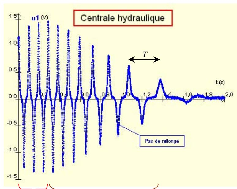
La chute d'eau met en rotation la turbine qui accélère. La valeur maximale de la tension augmente
