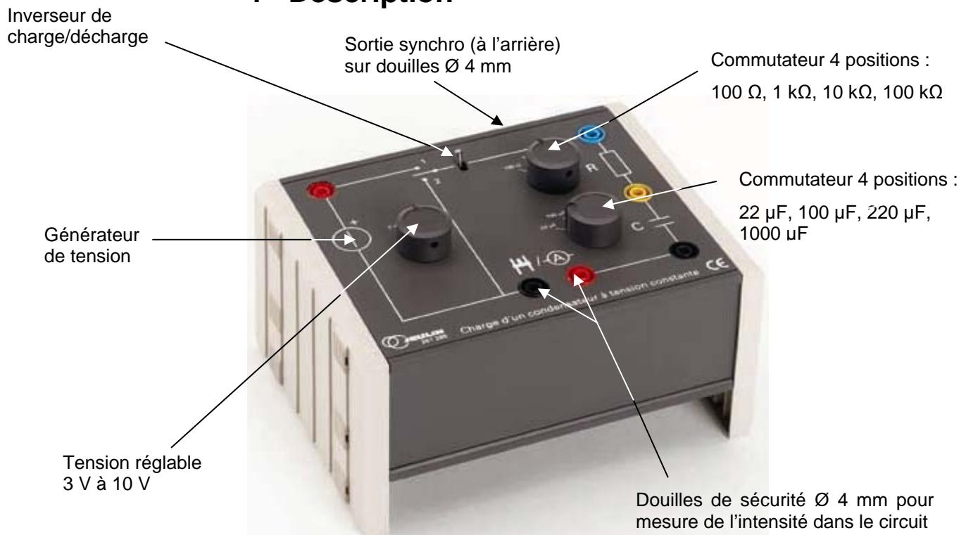
Le boîtier est constitué d'un générateur de tension, de 4 résistances et 4 condensateurs de valeurs différentes et d'un circuit de charge/décharge, commandé par un inverseur. Les douilles de sécurité, aux bornes du condensateur, permettent d'étudier la charge et la décharge à tension constante.
