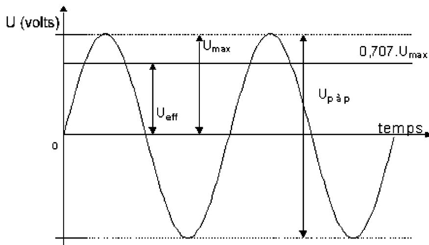
Les mesures à l'oscilloscope permettent de mesurer la tension efficace relevée à la prise de courant du montage :
