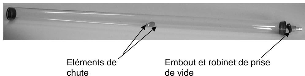
Tube en plastique muni de 2 embouts et d'un robinet de prise de vide, contenant 2 éléments de chute : une bille en acier et une rondelle de papier.
