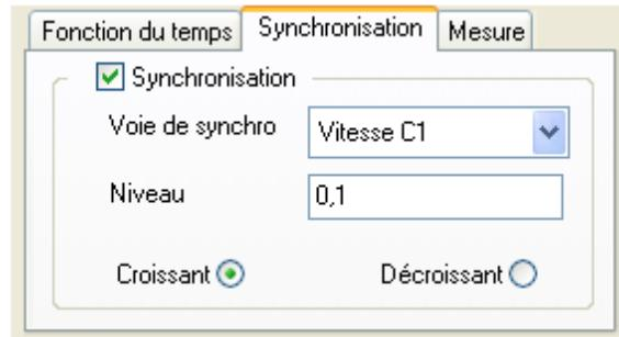
Remarque : Le niveau et le front croissant ou décroissant doivent être choisis en fonction du sens du déplacement et de l'orientation de la fourche.
