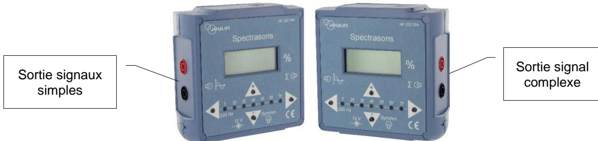
Les signaux simples, dont il est possible de réaliser les acquisitions successives sur la sortie prévue, sont activés à l'aide du sélecteur de fréquence (exemple : si 4F est sélectionné, la sortie simple correspond au signal à 4F).
