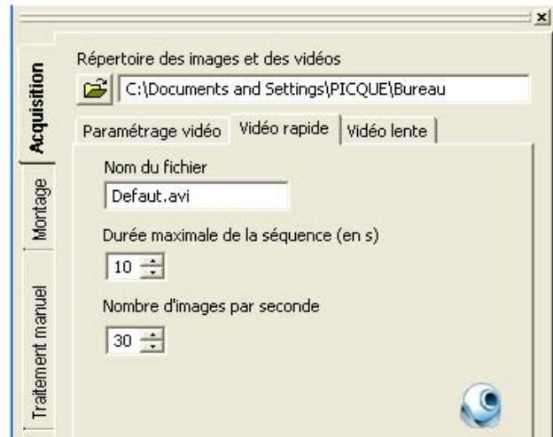
Lancer le pendule puis démarrer l'acquisition en cliquant sur l'icône webcam.
