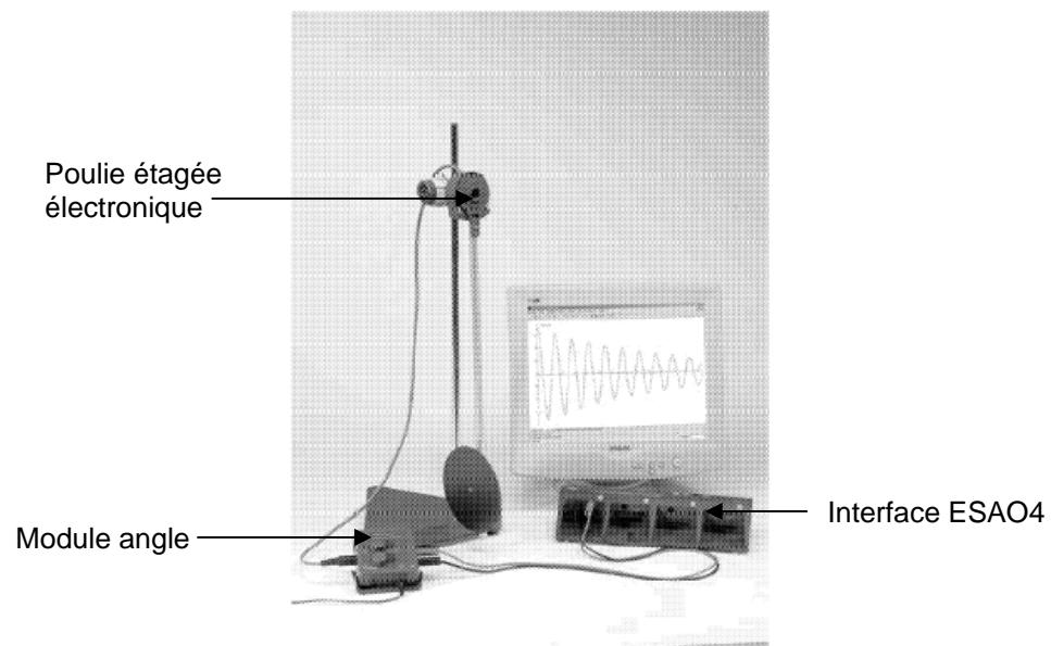
Exemple d'exploitation en Ex.A.O avec une interface ESAO 4, une poulie étagée électronique -réf : 453109 (complément non livré) et le module angle -réf : 453110 (complément non livré).
