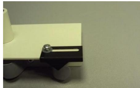
Ajuster si nécessaire le positionnement de l'index afin qu'il indique la bonne position sur la graduation du banc.
