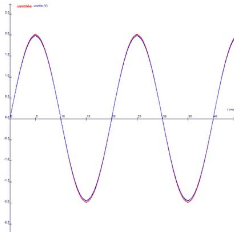
Relevés de la tension en entrée et sortie du câble coaxial de 100 m :
