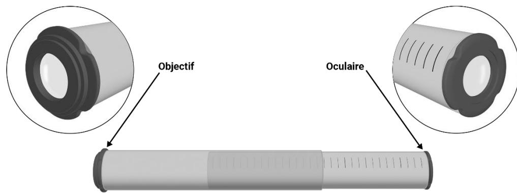
Le tube porte oculaire est gradué de 45 à 70 cm et accepte des composants oculaires de  $\varnothing = 40$  mm (lentilles ou dépoli), fixé sur une bague Clix.
