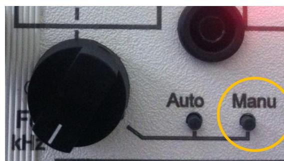
Ainsi à chaque appui sur ce bouton, la tension se bloquera au niveau de tension correspondant au moment d'appui du bouton.
