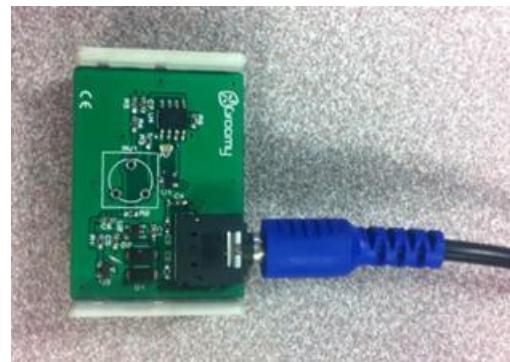
Ce capteur délivre une tension avec une réponse linéaire qui est l'image de la température qu'il mesure avec :
