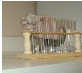
Introduire dans le tube à essai un volume ne dépassant les 3 cm de la capacité totale du tube. Pour mesurer un volume constant à chaque expérience, on peut utiliser une petite éprouvette. Ouvrir de la même façon si nécessaire le flacon contenant le réactif. Verser dans le tube l'équivalent d'1 cm de réactif
