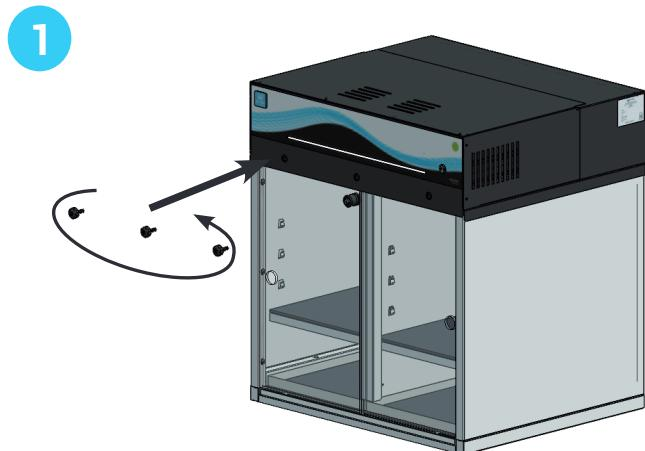
Débrancher l'appareil de la source d'alimentation électrique puis dévisser les trois vis du carter
