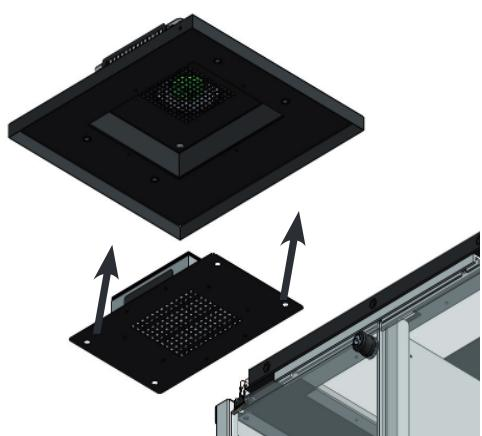
Insérer la trappe support du filtre HEPA
