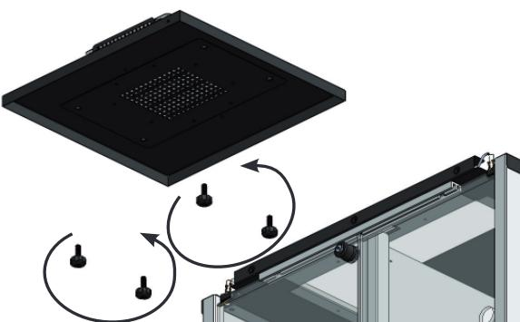
Visser les quatre vis de la trappe support du filtre HEPA
