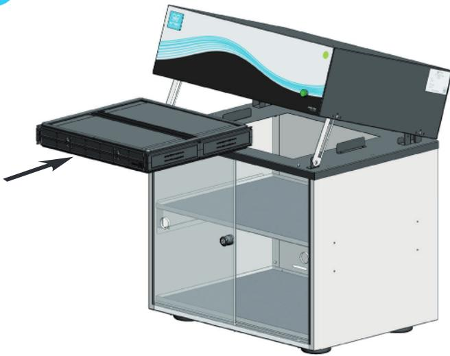
**Insérer le filtre carbone au fond de l'armoire puis le poser**
