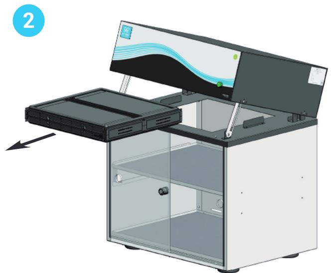
Sortir le filtre carbone de l'armoire
