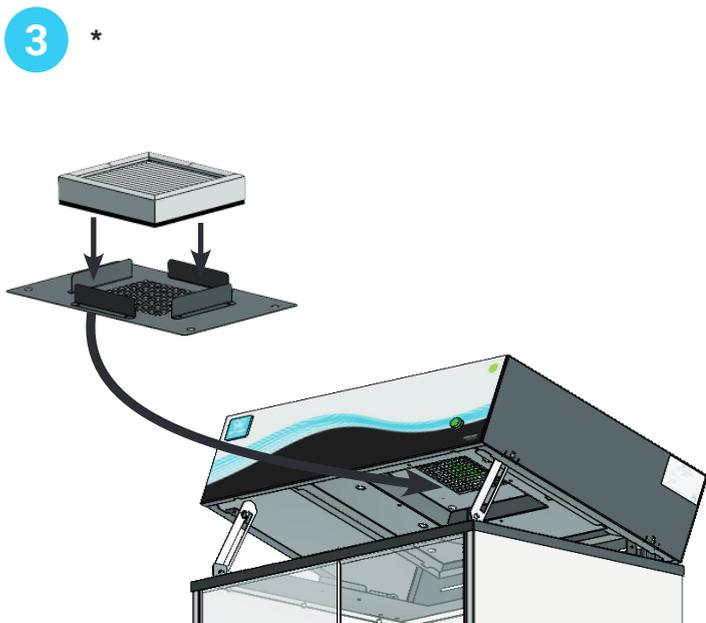
Installer le filtre HEPA dans la trappe support
