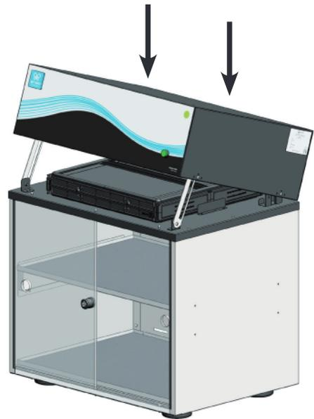
Refermer le carter de protection et rebrancher votre appareil à une source d'alimentation électrique
