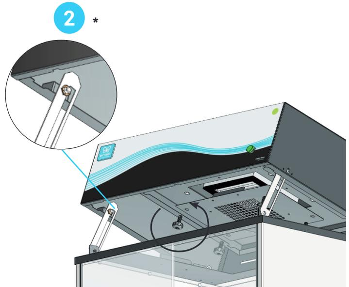
Dévisser les quatre vis de la trappe support du filtre HEPA
