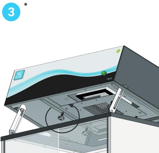
Dévisser les quatre vis de la trappe support du filtre HEPA
