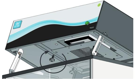
Visser les quatre vis de la trappe support du filtre HEPA
