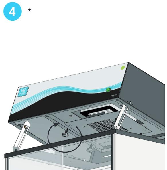
Visser les quatre vis de la trappe support du filtre HEPA
