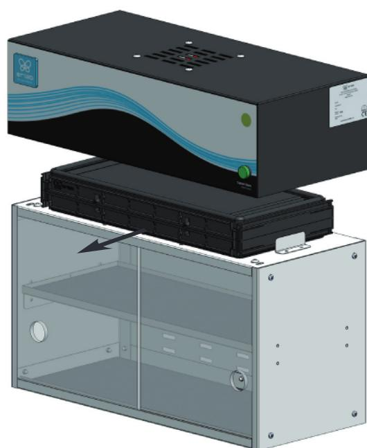
Sortir le filtre carbone de l'armoire
