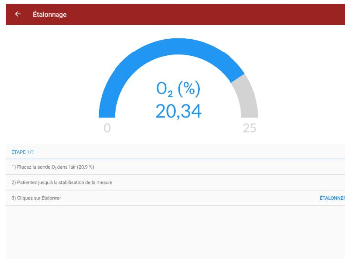
Après appui sur Etalonner, un écran de confirmation apparaît.
