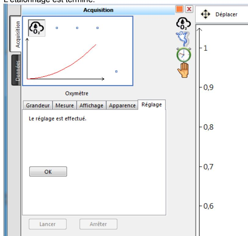
Vous pouvez vérifier dans l'onglet Mesure que la valeur mesurée est maintenant de 20.9 %, teneur de l'air en dioxygène.
