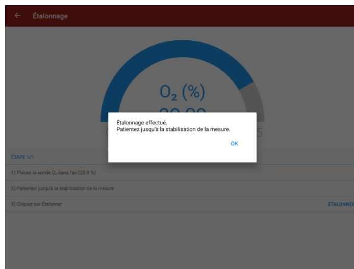
Cliquer sur OK. L'étalonnage de la sonde est terminé.
