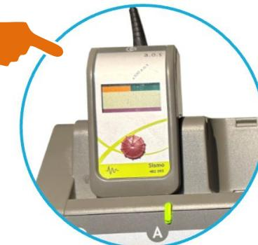
3 Poser la **cellule piezo-électrique** sur l'élément
