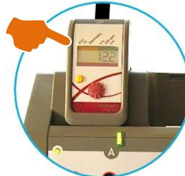
3 Connecter les câbles du capteur Electrophy aux **électrodes**
