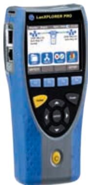
Analyseur de réseaux actifs et passifs pour le dépannage, la surveillance des flux et les diagnostics de performances
