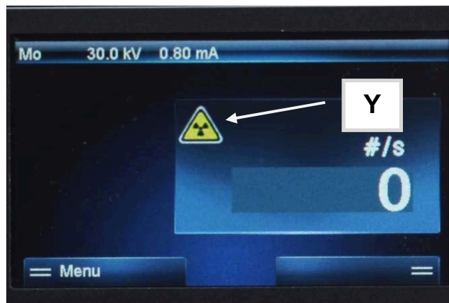
Fig. 11 : Affichage de l'écran de commande en face avant de l'appareil lorsque les rayons X (la haute tension) sont activés - le symbole Y s'affiche
