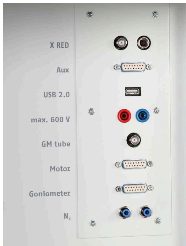
Fig. 7 Panneau de connecteurs de l'espace d'expérimentation
