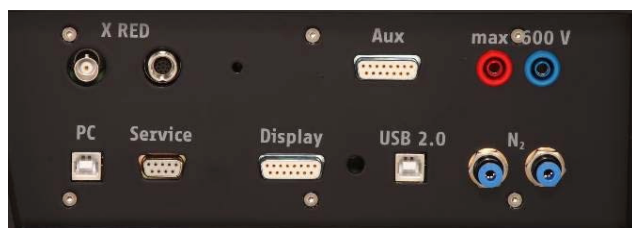
Fig. 8 : Panneau de connecteurs femelles situé sur le côté extérieur droit de l'appareil
