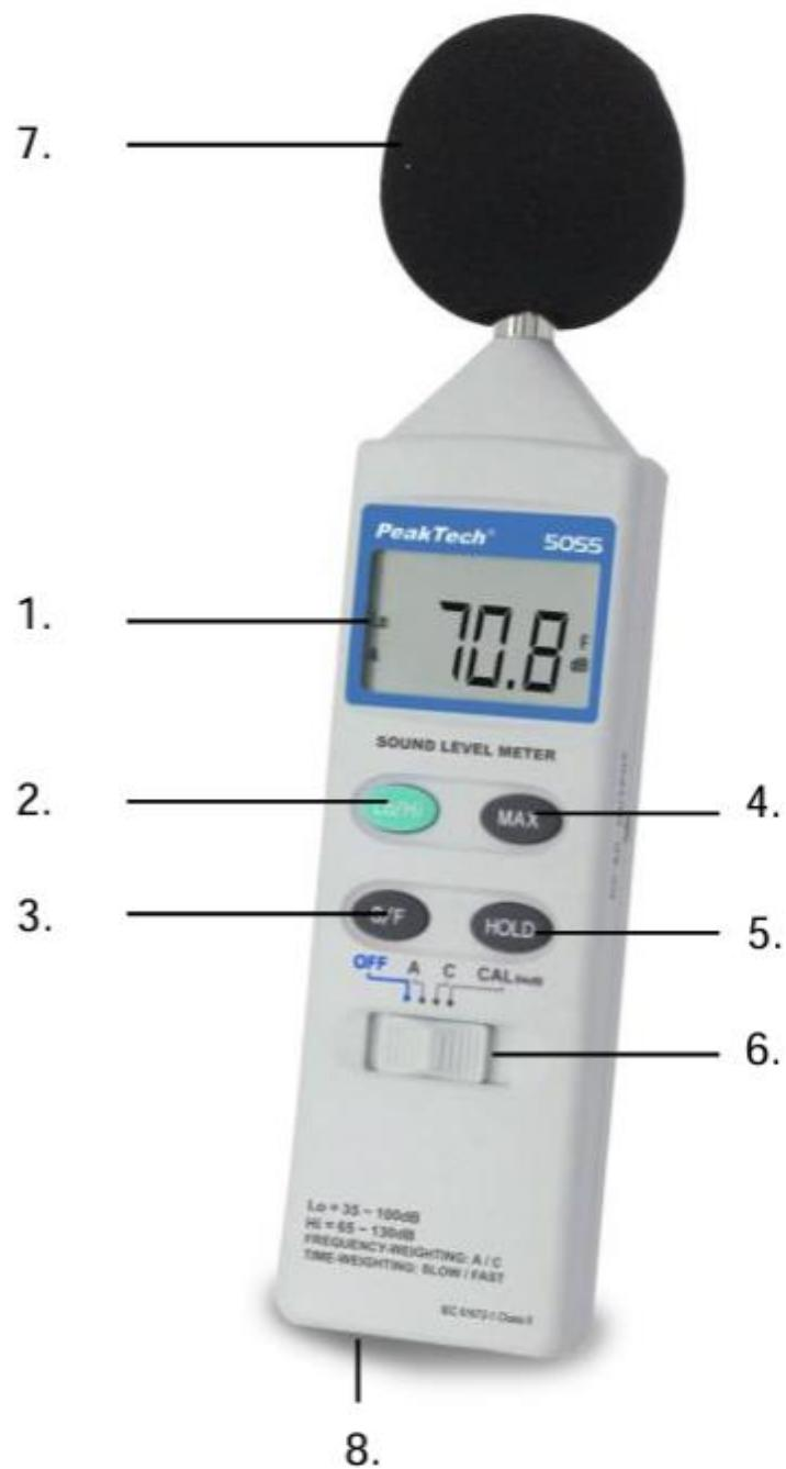
1. Affichage LCD : Écran LCD à 3 chiffres 1/2 avec indication des unités de dB, A, C, Lo, Hi et « BAT » MAX HOLD, DATA HOLD.
