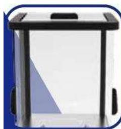
Corps en alliage d'aluminium et plate-forme en acier inoxydable avec paravent en verre transparent.
