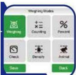
Multiples fonctions telles que le pesage, le comptage des pièces, le pesage en pourcentage, le pesage de contrôle, le pesage des animaux, la détermination de la densité (kits en option) avec des unités de pesage multiples.
