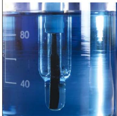
Lorsqu'une électrode InLab ISM (Intelligent Sensor Management) est connectée, l'instrument le détecte automatiquement et enregistre son ID, son numéro de série et les dernières données d'étalonnage. La durée de configuration de l'instrument est réduite ainsi que le risque d'erreur (grâce à la détection de l'électrode).
