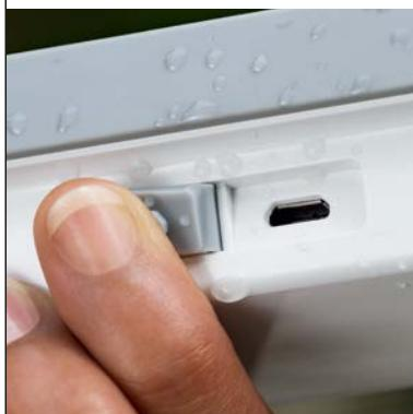
Grâce à leur indice de protection IP67 et à leur résistance aux chutes, les nouveaux instruments portables Seven2Go peuvent être utilisés dans des environnements difficiles. Le connecteur USB résistant aux conditions climatiques garantit la sécurité du transfert des données, même lors d'éclaboussures.
