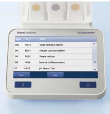
Des méthodes spéciales sont également incluses pour les techniques de mesure de concentration ionique par incrément les plus courantes, comme différentes méthodes d'ajout/de soustraction d'étalon et d'échantillon. Vous disposez ainsi d'un ensemble d'outils polyvalents et modernes pour effectuer des mesures professionnelles de concentration ionique !
