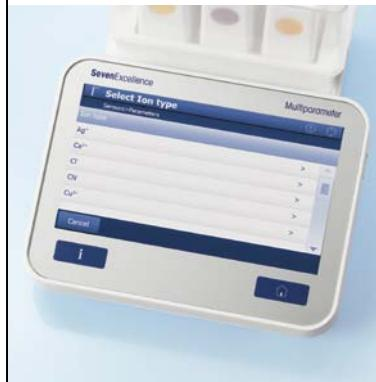
Les douze types d'ions les plus fréquemment utilisés sont pré-programmés dans l'instrument pour faciliter au maximum les réglages. Pour les autres ions, il vous suffit de saisir la charge ionique et la masse molaire et l'appareil effectuera pour vous l'ensemble des calculs et des conversions.
