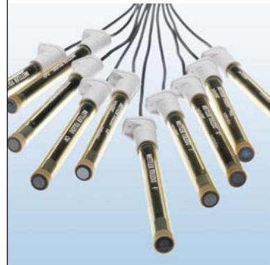
Avec SevenExcellence, il est possible d'utiliser notre gamme d'électrodes ioniques sélectives combinées perfectION™ ainsi que notre gamme de demi-cellules. Pour les mesures effectuées avec des demi-électrodes sélectives, une électrode de référence est nécessaire.
