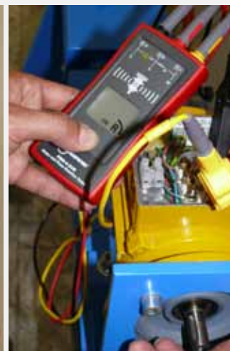
Vérification du sens de rotation du moteur avant d'établir la connexion
