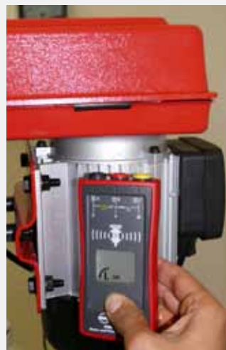
Détection sans fil du sens de rotation du moteur
